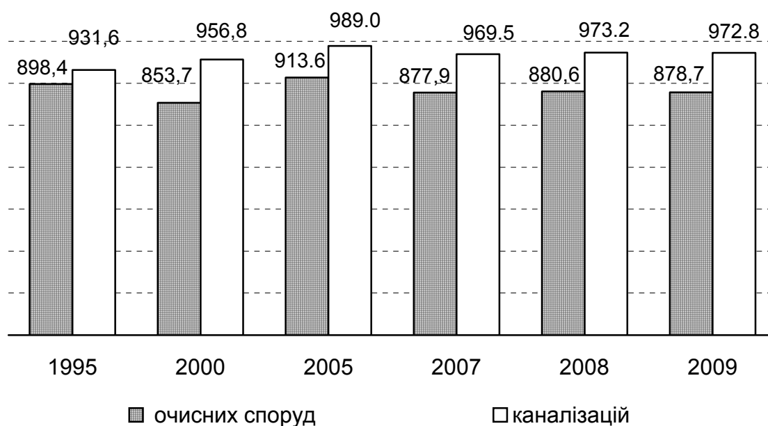
Установлена пропускна спроможність очисних споруд та каналізацій, тис.м 3
